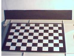
Figura 2. Plantilla de calibración usada
