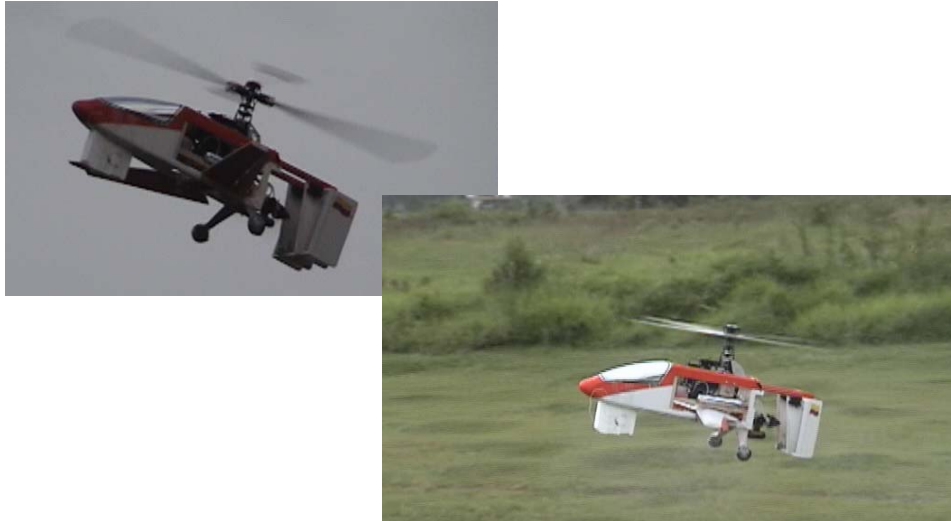
Figura 4. Vista posterior de la aeronave UAV EFIGENIA en donde se aprecia su control vectorial.
