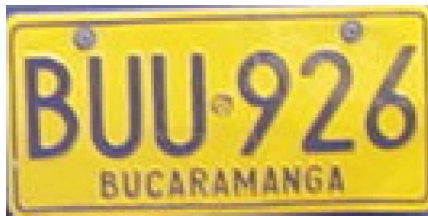
Figura 11. Resultado segmentación de placa usando espacio de color del nuevo modelo de Hering, considerando la iluminación generada por las luces del vehículo.
