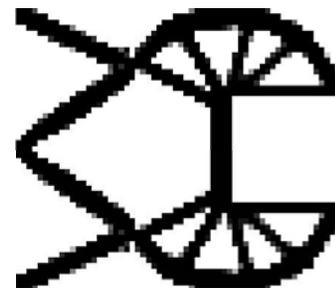
Fig. 7. Topología óptima para el ejemplo de la micro-pinza. El mecanismo se obtuvo en menos de 25 iteraciones
