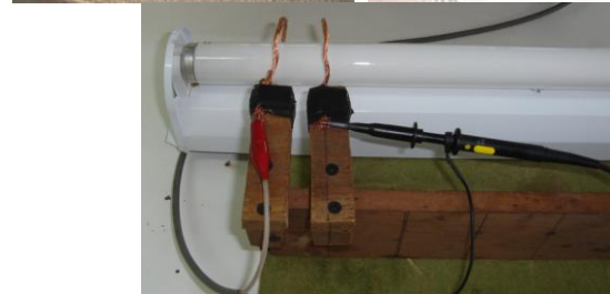
Fig. 5. Montaje experimental, los dos aros separados a una distancia de 5 cm
