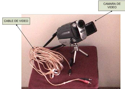
Fig. 6. Cámara de video encargada de la posición del robot y su ubicación en el salón para el sistema.
