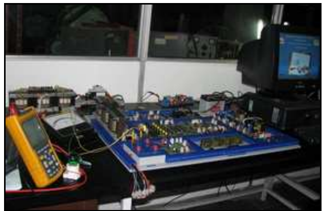
FIG. 12 Banco de pruebas para regulacion de un generador sincrono
